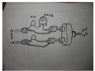
接続ケーブルの途中にコンデンサと 可変抵抗器を入れます。
