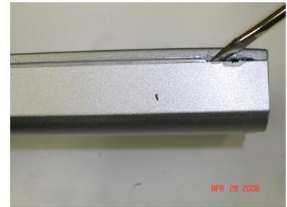
6 小ドライバーを使って少しずつ開きます。電池本体に傷を付けないように、細心の注意が必要です。
