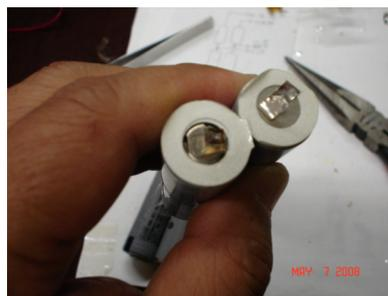
20 電池のタグを折り返し, 配線端子とハンダ付けします。タグと電池端子の両方にあらかじめハンダを盛っておきます。
