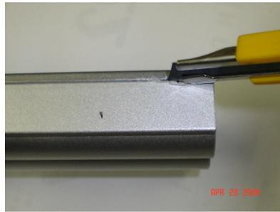
5 後ろの部分は、がっちり閉められているので、カッターで背面の端に少しだけ切り込みを入れます。
